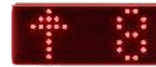
Табло матричное ТИМ2 - на базе матричных индикаторов. Может оснащаться голосовым сообщением номера этажа и перегрузки.
